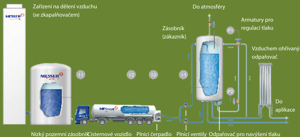
Ztráty chladicí energie a plynu při přepravě kapalného dusíku
