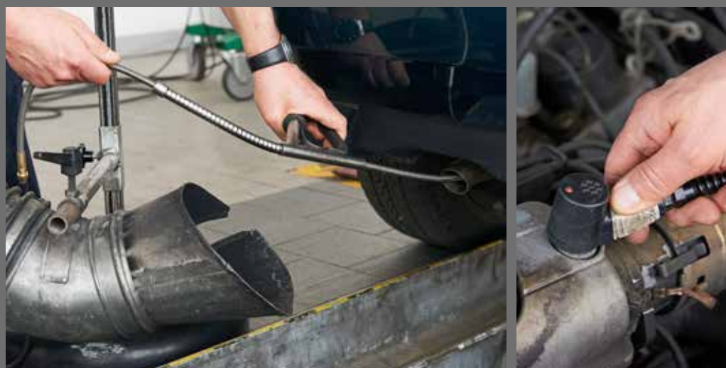
Alle zwei Jahre müssen Pkw in Deutschland zur Abgasuntersuchung. Dabei werden Messfühler am Auspuff und am Zylinderkopf angebracht.
