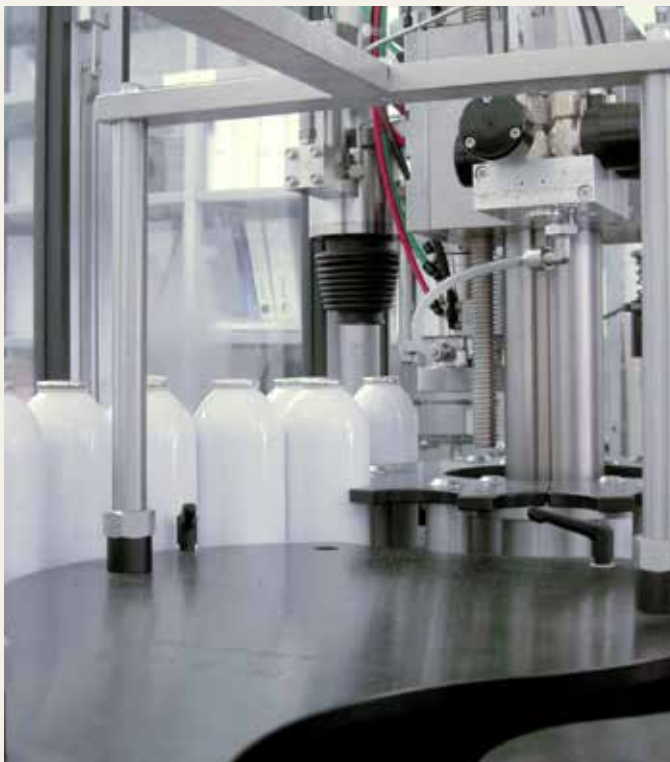
Abfüllung von hochreinen Null- und Kalibriergasen im Messer-Labor in Lenzburg, Schweiz
