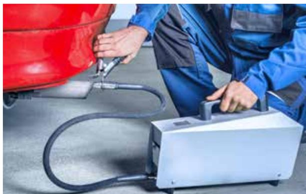
*Contrôle des gaz d'échappement d'un véhicule*
