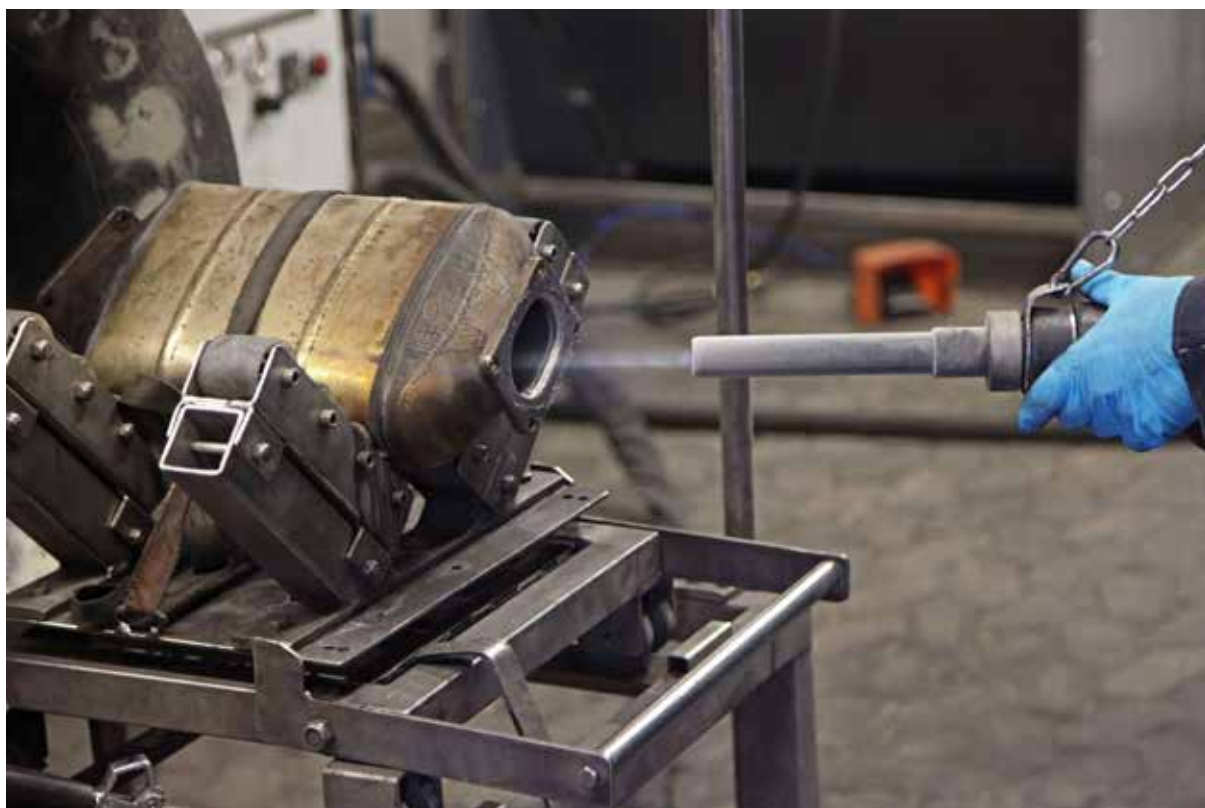
Obr. 1 - Detail čištění DPF filtru pomocí technologie IceMaster
