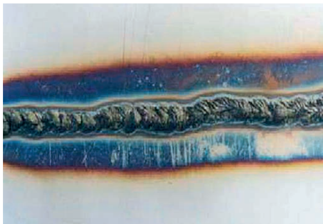
Obr. 1a – Kořen svaru bez použití formovacího plynu
