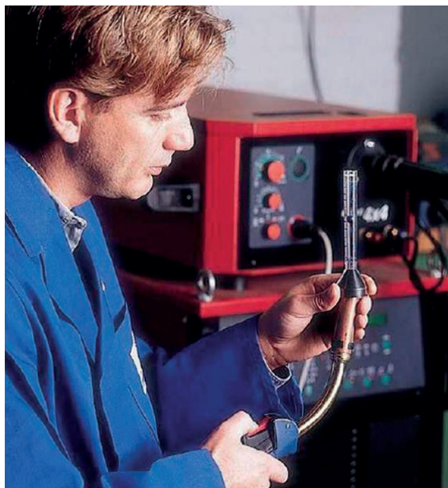
Obr. 4 – Měření průtoku ochranného plynu
