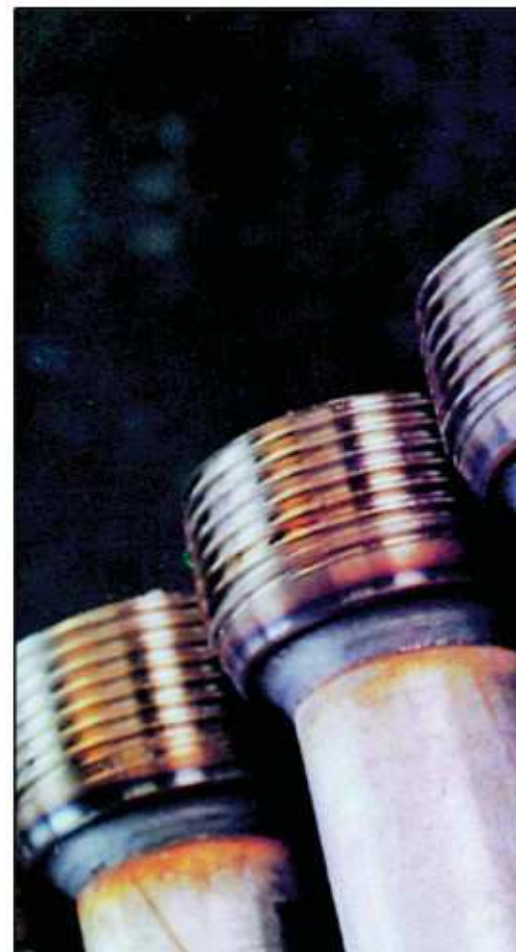
Vysokotlaké trubky (200 bar) zvarované metódou zvarovania ochranným plynom FERROLINE® C 18
