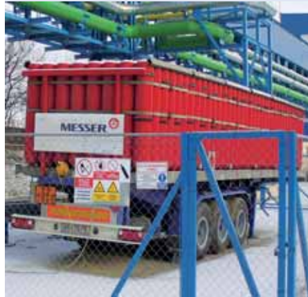
In solchen Batteriewagen hält U.S.Steel Wasserstoff vor.
