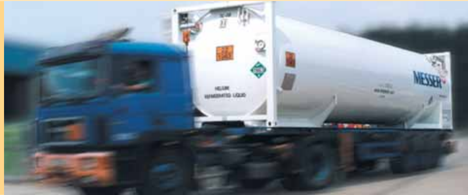
In speziellen Tankcontainern wird das flüssige Helium von der Quelle ins Füllwerk transportiert.
