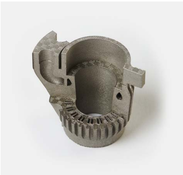
Gekühlte Schweißdüse aus CrNi-Stahl, entwickelt von ifw Jena
