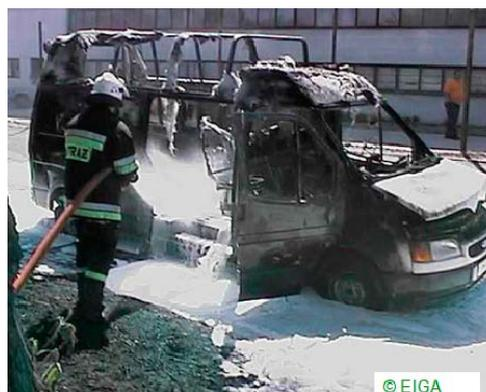
Eine undichte Acetylingasflasche hat sich in einem Lieferwagen am Flaschenventil entzündet. Der Fahrer konnte gerade noch entkommen. Das Fahrzeug brannte in nur zwei Minuten aus.
