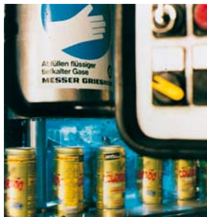
Rys. 5. Cryogen®-Injektor zintegrowany z instalacją rozlewającą
