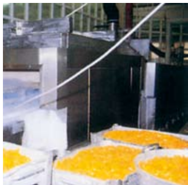
Zamrażanie kawałków owoców w tunelu Cryogen®
