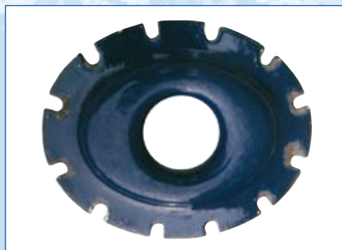
Smaltovaná aparatura očištěná bez poškození povrchu
