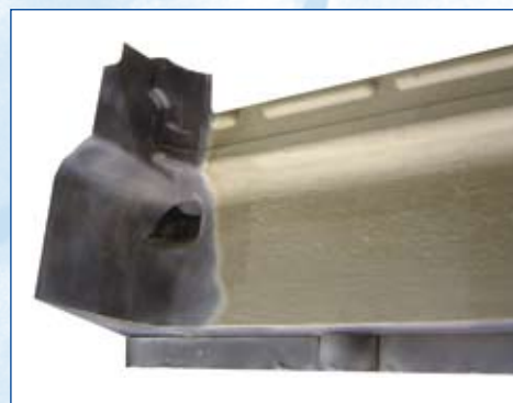
Odstranění separátoru ze zahřáté kokily spoří strojní čas a energii
