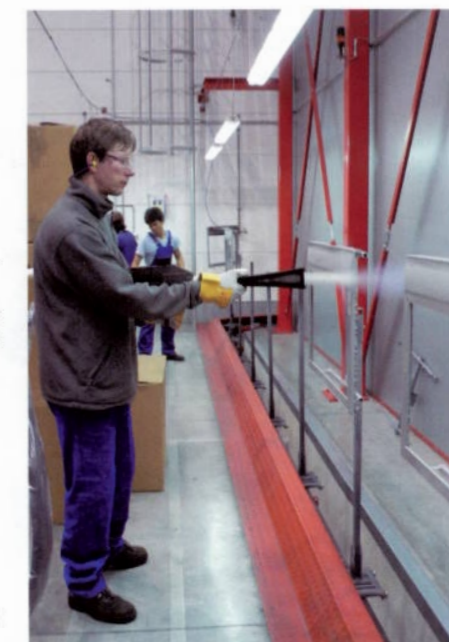
Ruční čištění plastových dílů suchým ledem před lakováním
